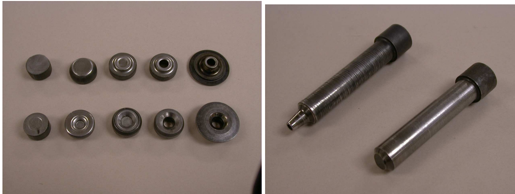
Bild 6: Stadiengang zur Fertigung des Ventildfedertellers und gebrochenes Werkzeug
