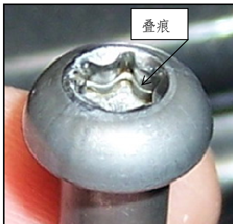
图 6 在凹槽处的叠痕非常准确的在模拟结果中显现出来
