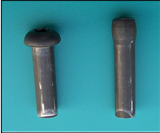
图 3: 最初的冷锻结果(老的设计)
