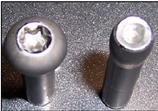
图 4: 带有预制凹槽的冷锻结果
