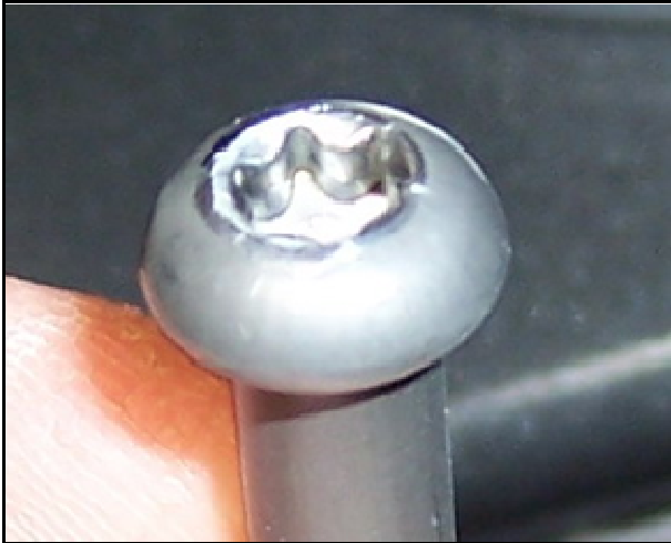
图 13: 产品样品 (新的设计) : 没有叠痕 优化后的工艺流程显示了完美的形状, 材料叠痕不再出现, 模具寿命明显延长。
