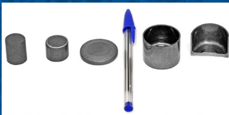
Einstufiger Prozess - Zunächst werden weiterhin die zwei ersten Operationen ausgeführt. Dann wird ohne zu glühen und zu phosphatieren eine einzelne Operation bei  $600^{\circ}\text{C}$  durchgeführt.
