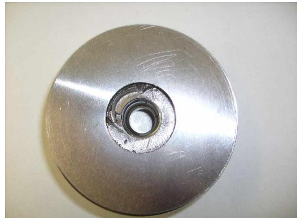
Bild 2: Ausbruch des Hartmetalls an der Matrize
