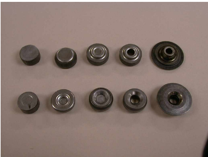
Bild 7: Fertigung eines Ventildertellers
