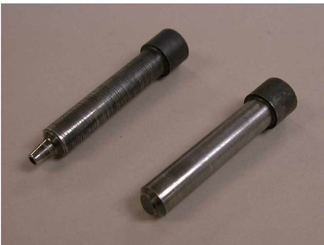
Bild8: Vorzeitiges Versagen eines Stempels
