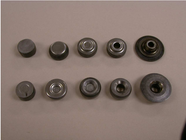
Abbildung 1: Stadiengang zur Fertigung des Ventildertellers
