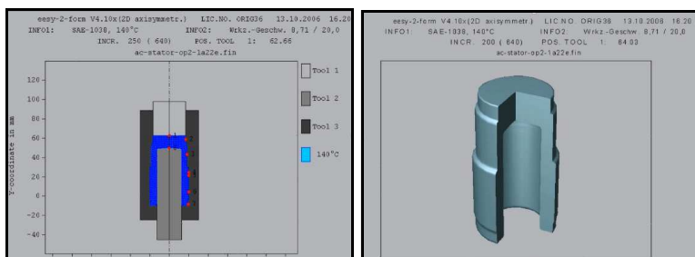
Bild 12: Ergebnisse einer Simulation (nicht in der Endposition und kopfstehend)
