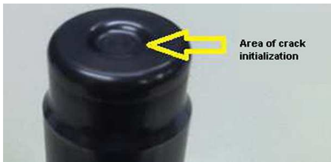
Bild 29: Bereich der Brucheinleitung
