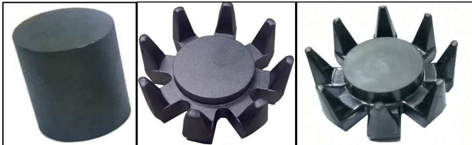
Bild 10: Produktionsfolge des Klauenpols (Warm Schmieden und Kaltkalibrieren)
