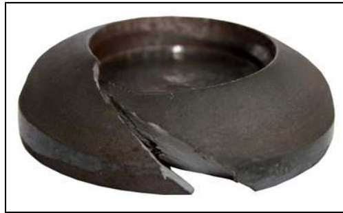
Bild 19: Werkstoffversagen in der ersten Operation
