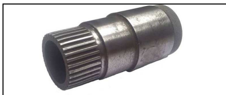
Bild 11: Verzahnungsteil in einer Stufe gepresst
