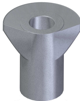
Bild 2: Teil mit nicht symmetrischem Aufstauchen bei gleichzeitigen Formen des Lochs
